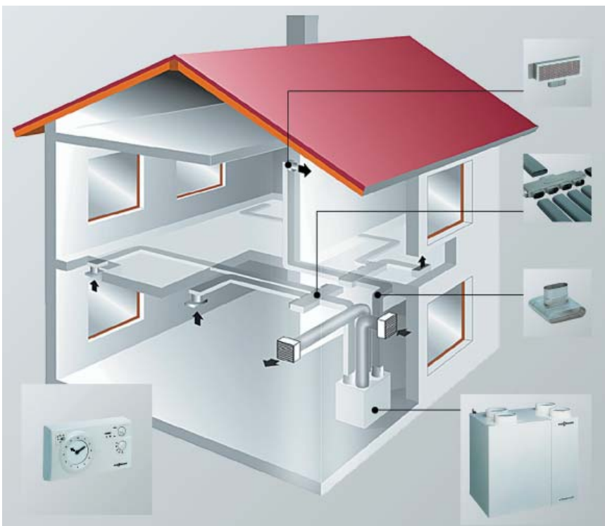
Rys. 4. Schemat obrazujący elementy systemu odzysku ciepła
