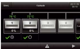
Vitotrol 350-C – ekran główny dla kaskady maksymalnie czterech kotłów z informacjami o kotłach
