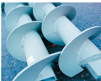
3 Wysokojakościowe, mocne wykonanie ślimaków transportowych
