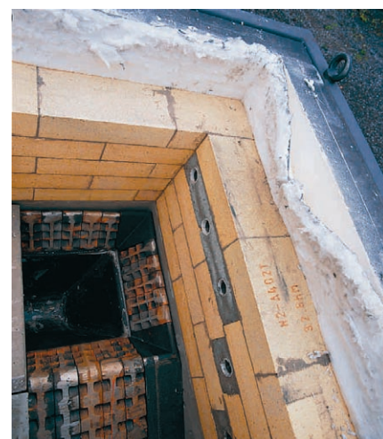
5 Struktura komory spalania – unikalna izolacja i wysokojakościowa wymurówka szamotowa.
