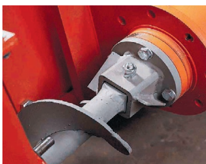
4 Wahliwe ułożyskowanie ślimaka, niewrażliwe na większe kawałki paliwa, gdyż umożliwia uchylanie się ślimaka w rurze
