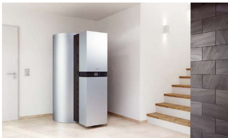
Vitosolar 300-FM – kompaktowa centrala grzewcza złożona z gazowego kotła kondensacyjnego, zbiornika buforowego wody grzewczej (poj. 750 litrów), armatury hydraulicznej i automatyki do współpracy z kolektorami słonecznymi dla wspomaganie centralnego ogrzewania domu
