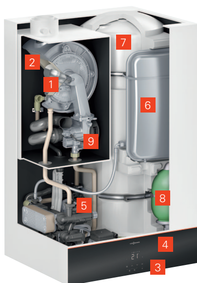
Vitodens 111-W (gazowy kocioł kondensacyjny, ze zintegrowanym zasobnikiem c.w.u. o pojemności 46-litrów)
