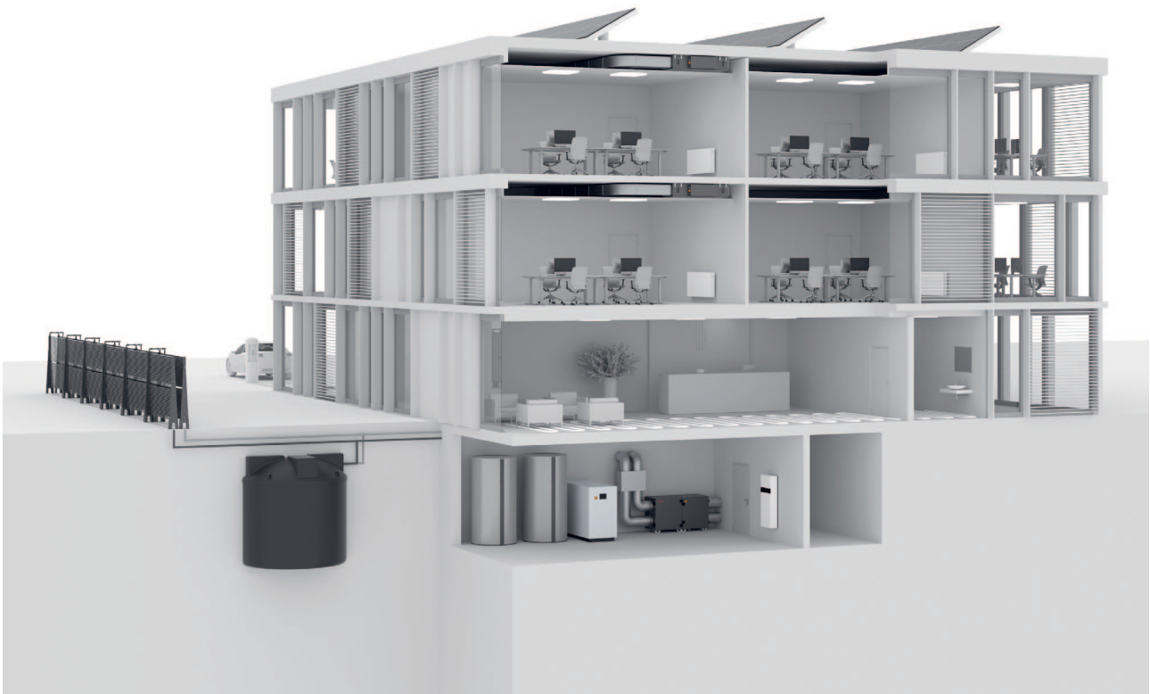
Budynek komercyjny z pompą ciepła solanka/woda Vitocal 350-G PRO z magazynem energii w lodzie
