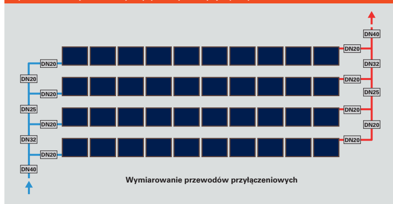
Rys. C.1.2-6 Projektowanie przepływu w polach pojedynczych
