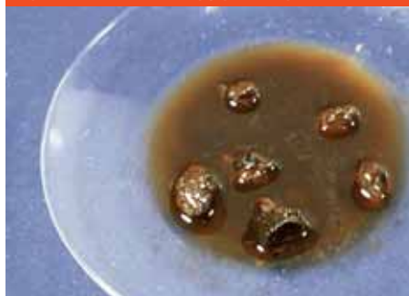
Rys. B.3.4–1 Uszkodzony płyn solarny
