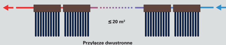
Rys. C.1.1-4 Warianty połączenia w pole kolektorów (Vitosol 200-T, typ SPE)
