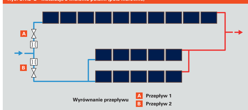
Rys. C.1.2-2 Instalacja z wieloma polami (pola nierówne)
