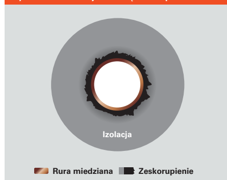
Rys. B.3.2–4 Izolacja ze strefą zeskorupienia
