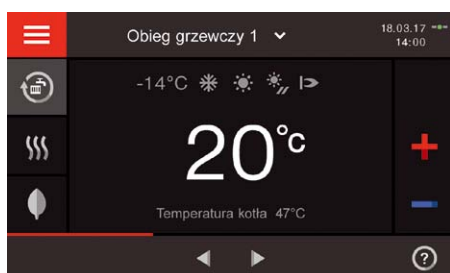
Nowy regulator Vitotronic 200 (typ H02C) z kolorowym, 5-calowym wyświetlaczem dotykowym
